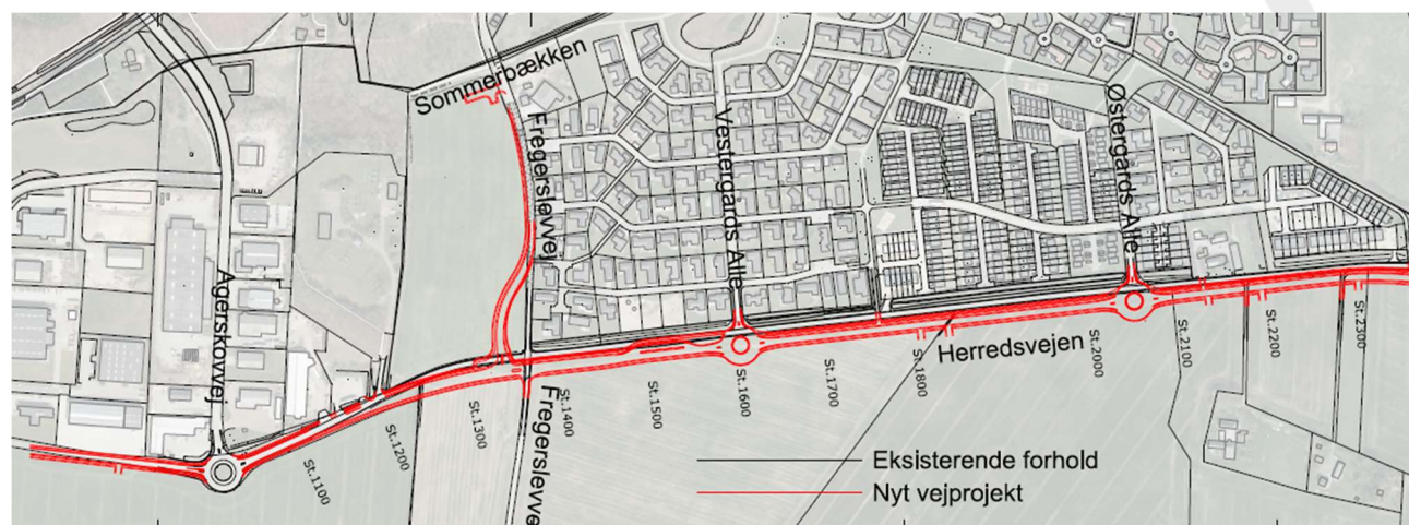
Figur 3: Oversigtstegning der viser vejprojektet der afvander til bassinet
